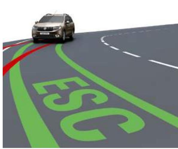
ESC: המערכת מאפשרת לייצב את מסלול הנסיעה של הרכב במקרה של אובדן אחיזה בעיקולים, בזכות התערבות בחלוקת הבלימה ובמהירות סיבובי המנוע.
