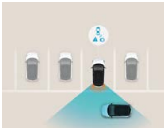
מערכת למניעת פגיעה ברכב חוצה בעת נסיעה לאחור (RCCW) מערכת המתריעה מפני רכב החוצה את מסלול הנסיעה לאחור.
