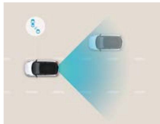
מערכת לזיהוי ומניעת התנגשות בכלי רכב ב"שטח מת" (BCA) מערכת למניעת התנגשות בעת מעבר נתיב המספקת התרעה על רכב ב"שטח מת".
