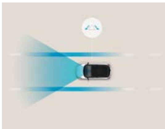
מערכת סיוע לשמירה על מרכז נתיב הנסיעה (LFA) מערכת אקטיבית המסייעת בשמירה על מרכז נתיב הנסיעה.
