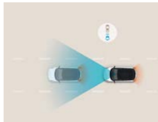
בלימה אוטונומית במצבי חירום (FCA) מערכת בלימה אוטונומית במצבי חירום הכוללת זיהוי הולך רגל, כלי רכב ודו-גלגלי.
