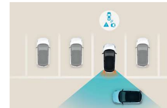
התרעה ומניעת פגיעה ברכב חוצה מאחור (RCTA)* מערכת אקטיבית להתרעה ומניעת פגיעה ברכב חוצה בעת נסיעה לאחור.
