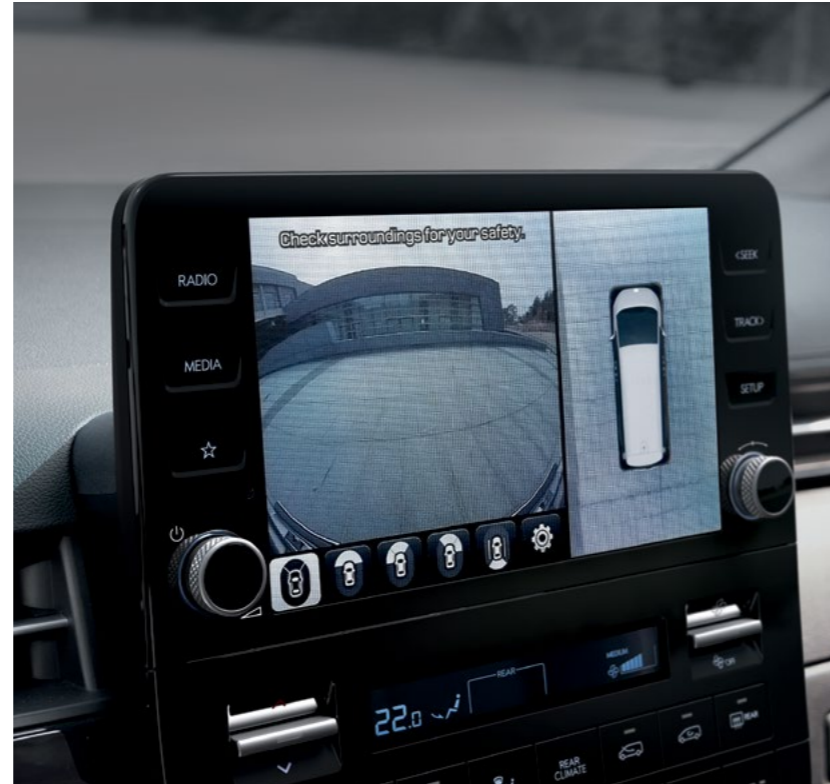
מערך מצלמות היקפיות (AVM)* יונדאי סטאריה מצוידת במערך 4 מצלמות היקפיות המאפשר זווית עין בכל זמן, של כלל סביבת המכונית.
