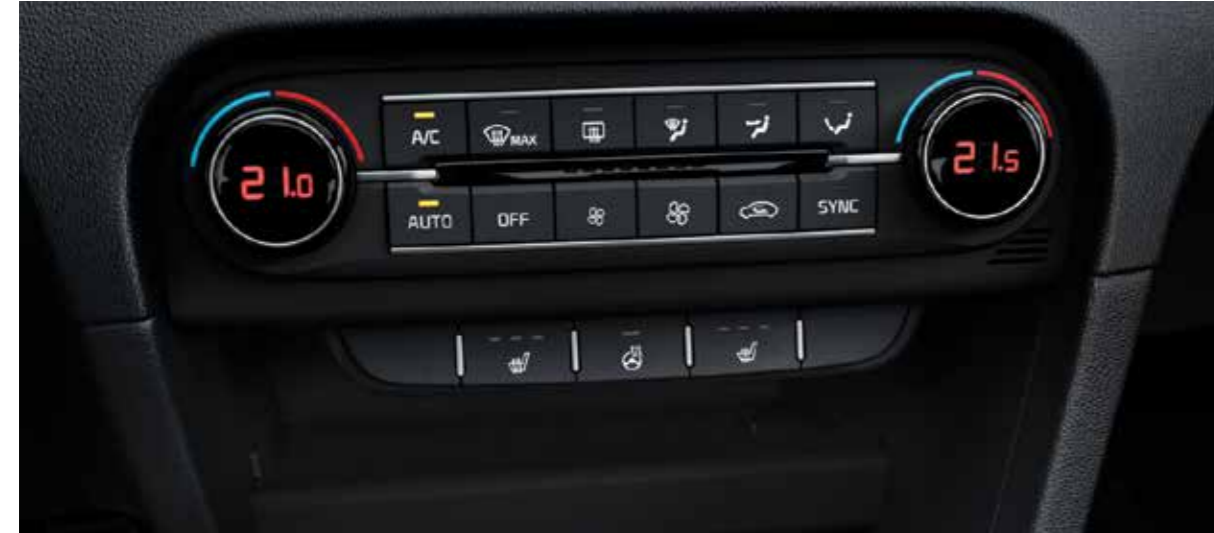
מערכת בקרת אקלים מפוצלת לשני אזורים מערכת בקרת האקלים המפוצלת מעניקה שליטה נפרדת על הטמפרטורה לנהג ולנוסע הקדמי.
