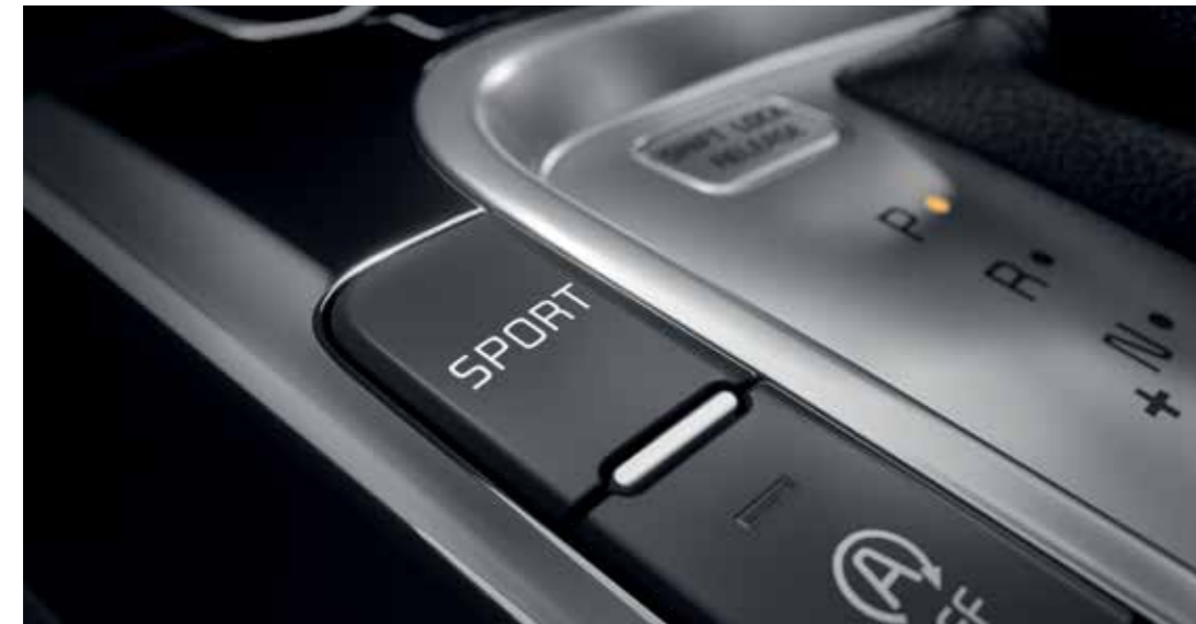
בורר מצבי נהיגה (DMS) בורר מצבי הנהיגה, המיועד לקחת את חוויית הנהיגה שלך לשלב הבא, ניתן להפעלה באמצעות כפתור ספורט לצד ידית בורר ההילוכים. בשילוב עם ה-DCT, הוא מגביר את דינמיקת הנהיגה על ידי שיפור תגובת המצערת והזינוק ממצב עמידה, וכן מבצע אופטימיזציה של הביצועים בעת עקיפה. DMS מציעה גם תגובת היגוי טובה יותר ומשלימה באופן מושלם את חישוקי הסגסוגת 18 אינץ' כדי להעניק נהיגה דינמית להפליא.
